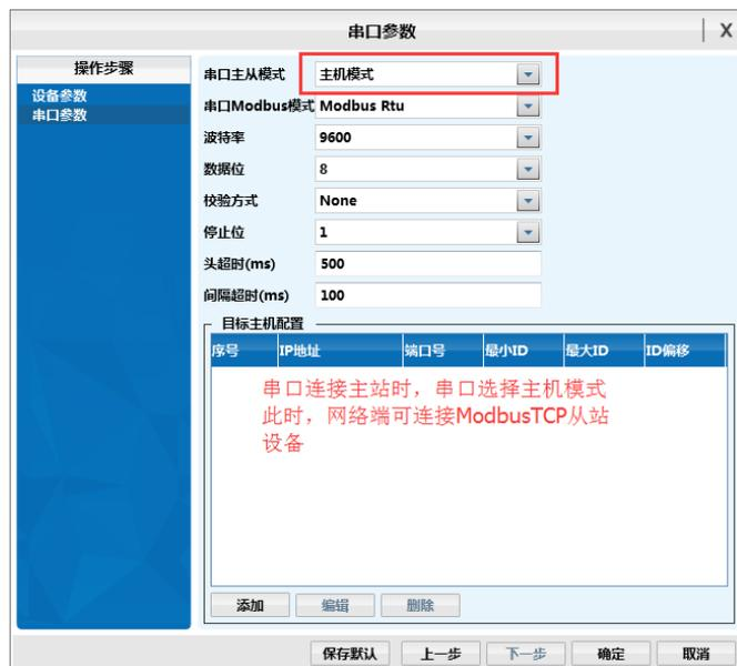
还需要添加ModbusTCP从站设备的信息。例如，要添加一台IP地址为10.1.1.12的ModbusTCP协议的IO模块，端口号为502，设备ID为1，点击
