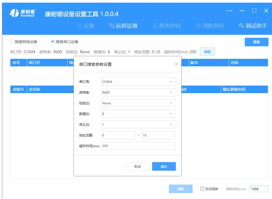
鼠标选择刚才搜索到的设备，点击上方“**设置**”标签，在弹出的对话框可以设置设备的串口参数，初次调测设备可以不修改设备的默认串口参数。
