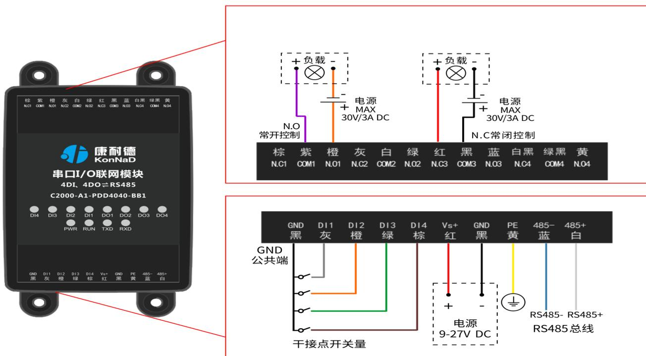
设备上电后，电源指示灯PWR红色常亮，运行指示灯RUN闪烁，设备供电正常。
