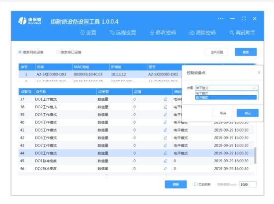
当DO为电平输出时,例如设置DO1点值为1时,此时DO1灯点亮,设置DO1点值为0时,DO1灯熄灭。 当DO为脉冲输出时,可通过设置DO脉冲宽度来控制DO状态。例如:设置DO1脉冲宽度为6000,改变DO1点值为 1,则DO1灯点亮,6s后灯熄灭。
