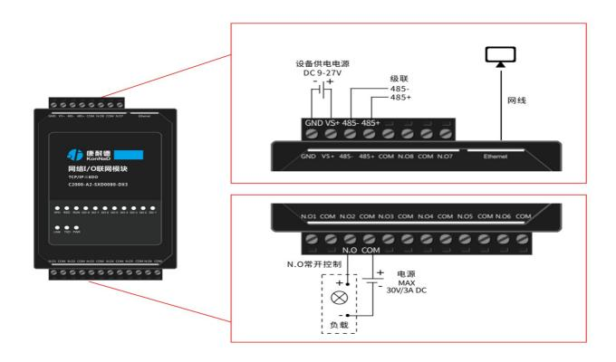
设备上电后,电源指示灯PWR红色常亮,运行指示灯RUN闪烁,设备供电正常。设备接上网线,网线另外一端插入电脑网口,网络指示灯SPD常亮、LINK闪烁,设备已接入网络。
