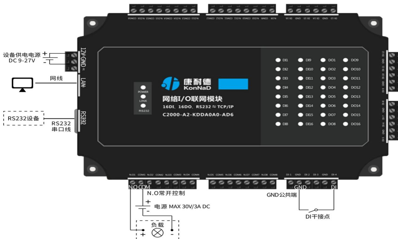
设备上电后，电源指示灯PWR红色常亮，运行指示灯RUN闪烁，设备供电正常。设备接上网线，网线另外一端插入电脑网口，网络指示灯SPD常亮、LINK闪烁，设备已接入网络。
