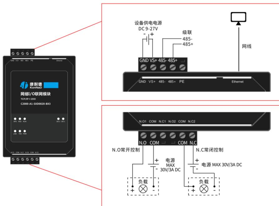
设备DC 9-27V供电后，电源指示灯PWR红色常亮，运行指示灯RUN闪烁，设备正常供电。设备接上网线，网线另外一端插入电脑网口，网络指示灯SPD常亮、LINK闪烁，设备已接入网络。
