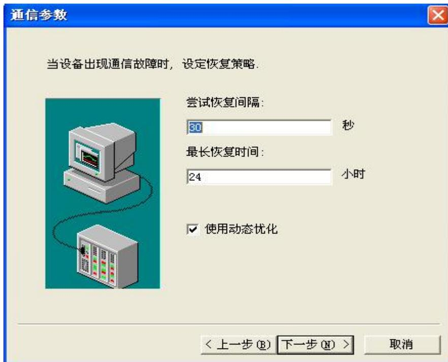
设置通信故障恢复参数(一般情况下使用系统默认设置即可)，单击“下一步”，弹出“设备配置向导”，如下图所示。
