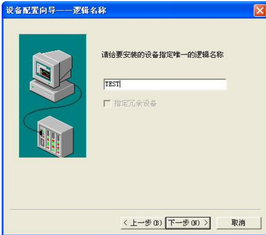
为设备取一个名称，在此输入 TEST，单击“下一步”，弹出“设备配置向导”，如下图所示。
