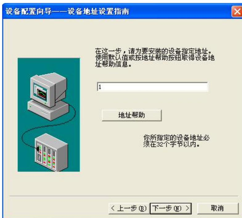
填写设备地址，设置为 1，单击“下一步”，弹出“设备配置向导”，如下图所示。
