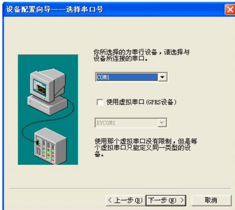
为设备选择连接串口，选择 COM1，单击“下一步”，弹出“设备配置向导”，如下图所示。
