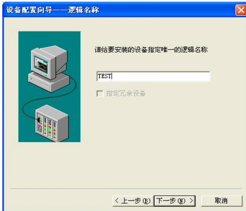
为设备取一个名称，在此输入 TEST，单击“下一步”，弹出“设备配置向导”，如下图所示。
