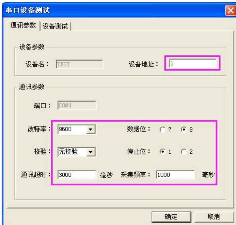
选择“通讯参数”选项，将通讯参数设置为“9600、N、8、1”。通讯超时和采集频率选择默认即可。选择“设备测试”项，界面如下图所示：
