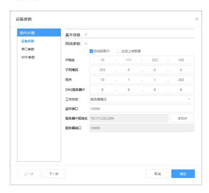
自动获取 IP: 如果勾选"自动获得 IP地址",那么此设备所在网段当中的 DHCP 服务器将为其自动分配 IP 地址,但仍需**手动设置上本网段默认网关**;如不勾选"自动获得IP地址"需要手动为其指定 IP 地址和子 网掩码、默认网关;
