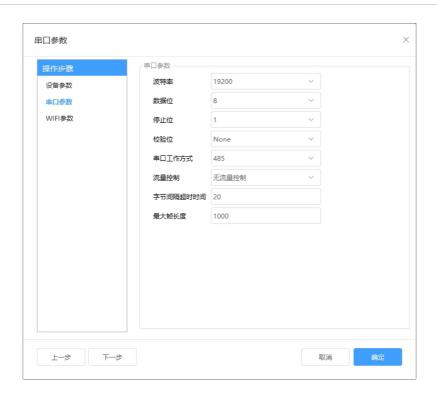
此 RS485 接口可以接同样为RS485接口的设备,并且这个下接 485 设备必须使用的是 MODBUS RTU 协议。当一个使用 MODBUS RTU 协议的设备连接到这个 RS485 接口上时,上位机可以使用 MODBUS TCP 协议对此 MODBUS RTU 设备进行访问,即 WIFI IO进行了 MODBUS TCP 协议和 MODBUS RTU 协议之间的转换,充当了 MODBUS 网关的角色。
