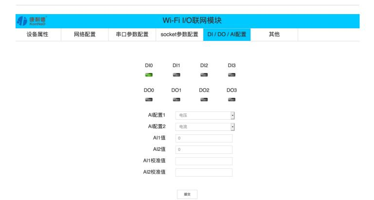
**DIO~DI3**: 当 DI 闭合时 DI 对应的指示会对应的变成绿色,当 DI 为断开状态时对应的指示变为灰色。 **DOO~DO3**: 当 DO 闭合时 DO 对应的指示会对应的变成绿色,当 DO 为断开状态时对应的指示变为灰色。
