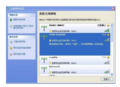
注:如连接不上可以长按 AP/STA 按键,将设备恢复出厂设置后重新连接
